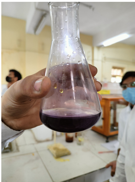
高锰酸钾滴定的实验照片，溶液的紫色来自 \text{MnO}_4^- 。原图未注明被滴定物、浓度或滴定阶段，因此不能仅凭照片判断终点。Bhaiyaji Smile 123 / Wikimedia Commons, CC BY 4.0。
